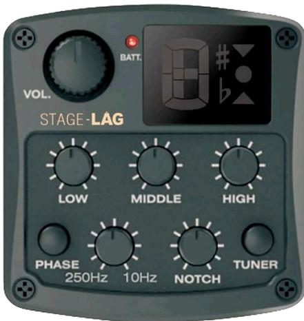
1 Lorsque le câble de sortie est **connecté** au **STAGE-LAG**, il démarre automatiquement. Lorsque le câble de sortie est retiré, il s'éteint automatiquement.
