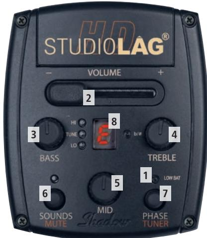
**6 SOUNDS/MUTE** a plusieurs fonctionnalités. Lorsque le câble est branché, il s'allumera en bleu («Linear setting»). Lorsqu'il est poussé, il s'allumera en vert («Acoustique clean»), lorsqu'il est poussé à nouveau, il s'allumera en violet (Rock setting) et une dernière pression allumera en rouge («jazz setting»). Lorsque le bouton est enfoncé pendant 2 secondes, la sortie sera en sourdine. Pour la réactiver, appuyez à nouveau brièvement sur le bouton.
