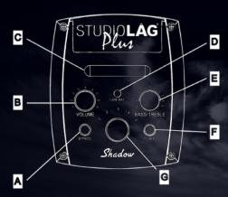
A MODE BYPASS: le signal est dérivé à travers l'appareil avec mise en mémoire tampon mais sans optimisation du préampli EQ.
