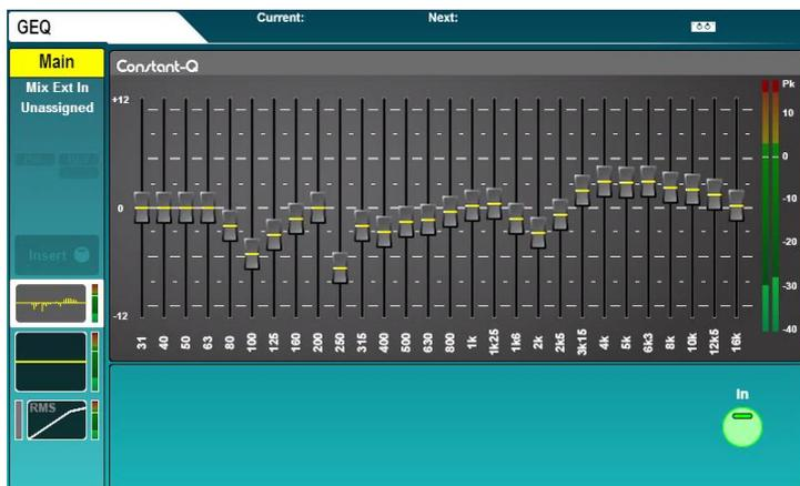
Tous les canaux de mixage disposent d'un égaliseur graphique stéréo à 28 bandes. Lorsqu'un canal de mixage est sélectionné et que le GEQ est activé, la LED verte **In** de la section GEQ s'allume (sous les encodeurs EQ).
