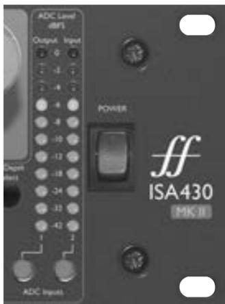
Ces deux rangées de Leds permettent de contrôler le signal entrant (rangée de droite) et le signal sortant (rangée de gauche). Elles permettent aussi de contrôler les niveaux de la carte A/N optionnelle quand les boutons ADC Input 1 et ADC Input 2 sont enfoncés. Les niveaux montrés s'échelonne entre  $-42\text{dBFS}$  ( $-20\text{dBu}$ ) et  $0\text{dBFS}$  ( $+22\text{dBu}$ ).
