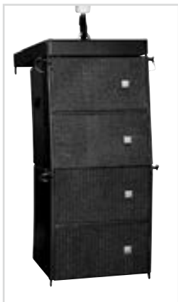
Abb. 10: Hochfahren der montierten CTA 208
