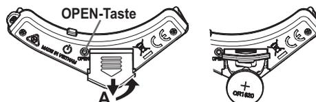
2. Um die korrekte Polarität zu gewährleisten, legen Sie die neue Batterie so ein, dass die „+“-Seite sichtbar ist.
