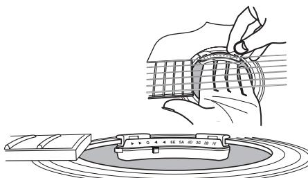
**AVANT D'ATTACHER LE RIMPITCH** Le Rimpitch peut être monté sur toute guitare dotée d'une rosace circulaire d'un diamètre de 100 mm (+/- 3 mm).
