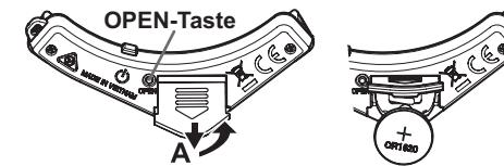
**2. Um die korrekte Polarität zu gewährleisten, legen Sie die neue Batterie so ein, dass die „+“-Seite sichtbar ist.**
