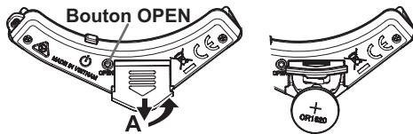
**2. Remplacez la pile en veillant à respecter la polarité: la face "+" de la pile doit être visible.**
