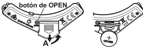
2. Inserte la batería asegurándose de que la polaridad es correcta, de forma que la cara "+" de la batería sea visible.
