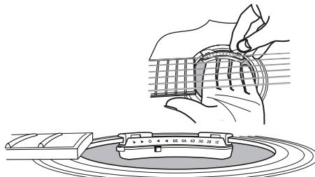
El Rimpitch se puede colocar en cualquier guitarra en la que la boca del instrumento tenga un diámetro circular de 100 mm +/- 3 mm.
