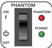
**(1) Alimentation fantôme** — Si vous connectez un micro ayant besoin d'une tension supplémentaire de 48 V, activez l'alimentation fantôme avec l'interrupteur situé sur la face arrière de la console de mixage.
