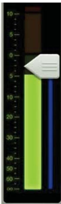
Les faders tactiles permettent de régler le niveau des voies envoyées à la sortie sélectionnée. Il suffit de toucher et de tirer le fader vers le haut ou le bas pour effectuer le réglage. Si vous touchez un fader, il passe en mode "grow & glow". Le fader peut être réglé de  $-\infty$  à +10 dB, comme indiqué par la graduation située à gauche (voir ci-contre).
