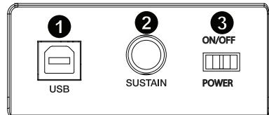
**NOTA:** La polarità del pedale sustain viene determinata dalla tastiera al momento dell'accensione. Quando la tastiera Keystation viene alimentata, il pedale sustain viene ritenuto in posizione “sollevata” (ossia, disattivato). È importante che il pedale sustain non sia premuto durante l'avvio, altrimenti viene invertito il funzionamento del pedale e le note verranno sostenute quando esso non è premuto.
