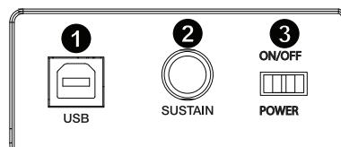
**HINWEIS:** Die Polarität des Sustain-Pedals wird automatisch ermittelt, sobald Keystation eingeschaltet wird. Standardmäßig wird davon ausgegangen, dass das Sustain-Pedal auf "AUS" (nicht gedrückt) steht. Deshalb sollten Sie das Pedal beim Einschalten des Keyboards nicht betätigen, denn andernfalls wird es verkehrt betrieben, was zur Folge hat, dass die Noten gehalten werden, wenn das Pedal nicht gedrückt wird.
