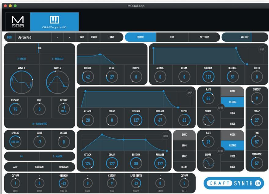
C'est l'onglet principal pour la conception et l'édition de patch. Vous y trouverez les sections oscillateur, filtre, enveloppe, LFO, arpégiateur, sustain, modulation et effets.
