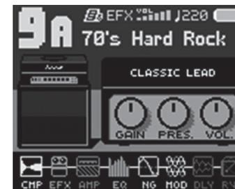
Sounds ist extrem einfach. Drücken Sie die EDIT-Taste und verwenden Sie die GROUP-MODULE-Tasten, um den Cursor nach links und rechts zu bewegen und eine Effekteinheit auszuwählen. Anschließend stellen Sie den Sound mit den GAIN-, LEVEL- und MASTER-Reglern ein.
