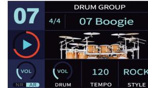
REGLER 1 steuert LOOP VOL. Durch kurzes Drücken passen Sie die MONO/STEREO-Aufnahme an. Durch langes Drücken öffnen Sie die NR/AR-Auswahl. NR bedeutet „Normal Recording“ für den regulären Phrase-Loop-Betrieb. AR steht für „Auto Recording“: Wenn Sie den Fußschalter LOOP drücken, ist das Gerät bereit, eine Phrase aufzunehmen, während Sie das Instrument spielen. Drücken Sie REGLER 1 lange, um die NR/AR-Auswahl zu schließen.
