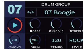
REGLER 3 steuert das TEMPO. Drehen Sie den REGLER 3, um DRUM BPM anzupassen. Alternativ tippen Sie das Tempo über REGLER 3 per Tap Tempo ein.
