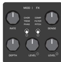
Im PRESET MODE oder im EDIT MODE können Sie mit den Reglern RATE, DEPTH und LEVEL ① die Parameter im MOD-Block einstellen. Mit den Regler SENSE und LEVEL ② stellen Sie die Parameter im FX-Block ein.
