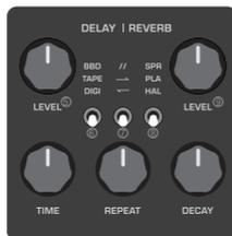
Im PRESET MODE oder im EDIT MODE können Sie mit den Reglern LEVEL ⑤, TIME und REPEAT die Parameter im DLY-Block einstellen. Mit den Regler LEVEL ⑨ und DECAY stellen Sie die Parameter im RVB-Block ein.
