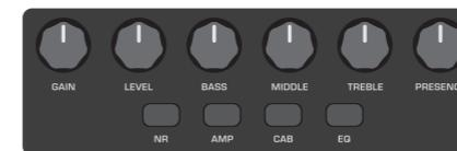
Im PRESET MODE können Sie durch Drücken der Tasten NR, AMP, CAB und EQ die entsprechenden Blöcke aktivieren/deaktivieren.
