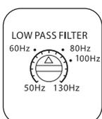
**Filtre passe-bas :** cette commande fixe la limite haute de la plage de fréquences reproduites par le Temblor T8. Si vous avez activé le filtre passe-haut intégré, réglez la commande de filtre passe-bas sur la même valeur. Sinon, réglez la commande de filtre passe-bas sur la fréquence la plus basse que peuvent fiablement reproduire vos moniteurs principaux.
