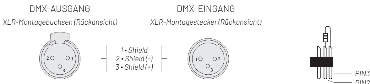
In professionellen Anwendungen schreibt der DMX512-Standard vor, dass am letzten DMX-Gerät in der Kette ein "DMX-Terminator" vorhanden sein muss, um die Signalloop korrekt abzuschließen. Dieser Terminator besteht aus einem 120-Ohm-Widerstand, der zwischen Pin 2 und Pin 3 des XLR-Steckers platziert ist.
