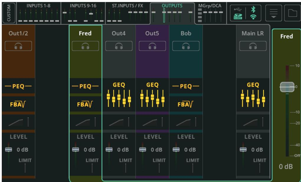
La banque de sorties Outputs comprend les canaux de traitement des six sorties individuelles et de la sortie principale Main LR.
