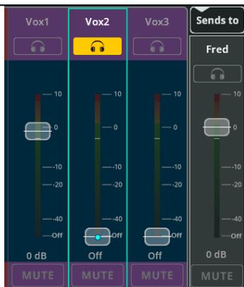
3. Montez le fader de n'importe quelle entrée afin d'envoyer le signal correspondant à la sortie sélectionnée.
