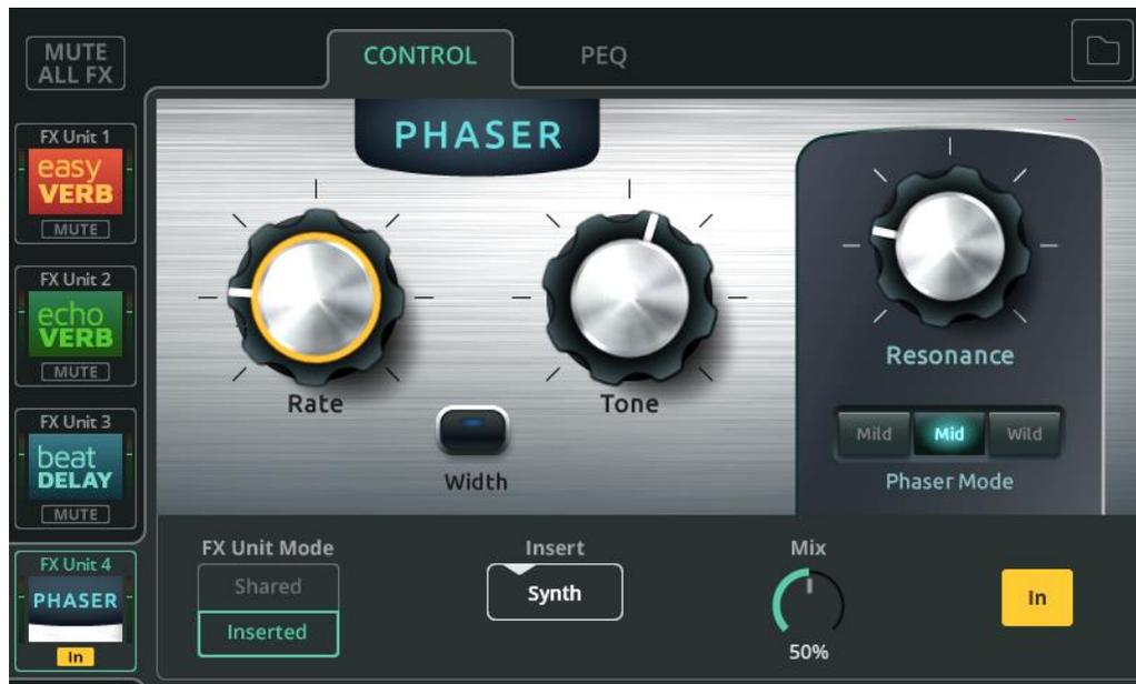
Le Phaser combine le signal d'origine et une copie du signal avec un déphasage appliqué à différentes fréquences. Certaines fréquences s'annulent alors que d'autres sont renforcées.
