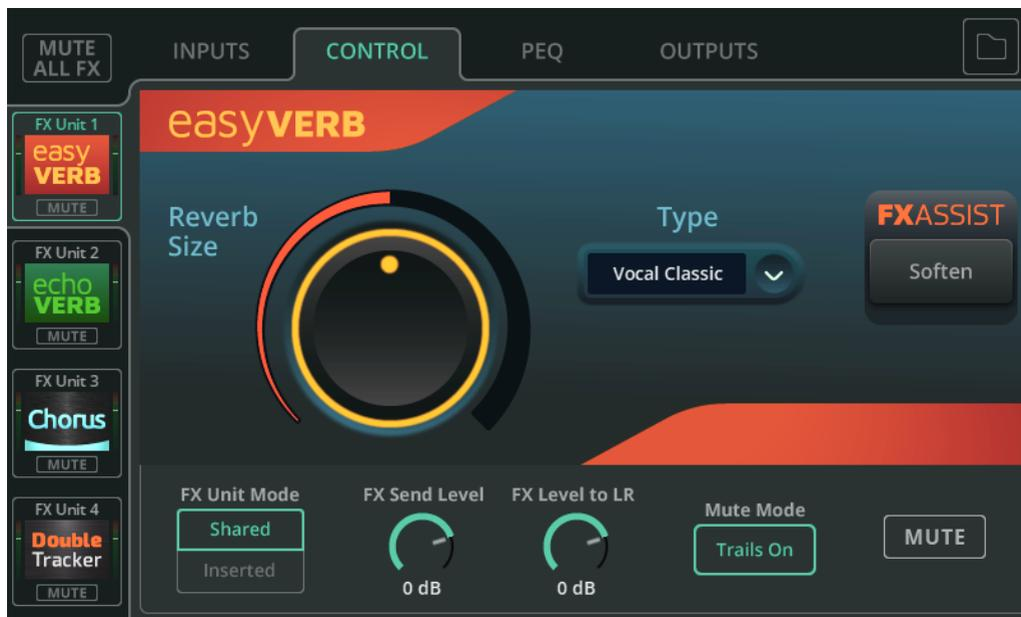
Sélectionnez une unité d'effet à régler dans le panneau de gauche. Les commandes du modèle d'effet sont affichées dans la section principale de l'écran.
