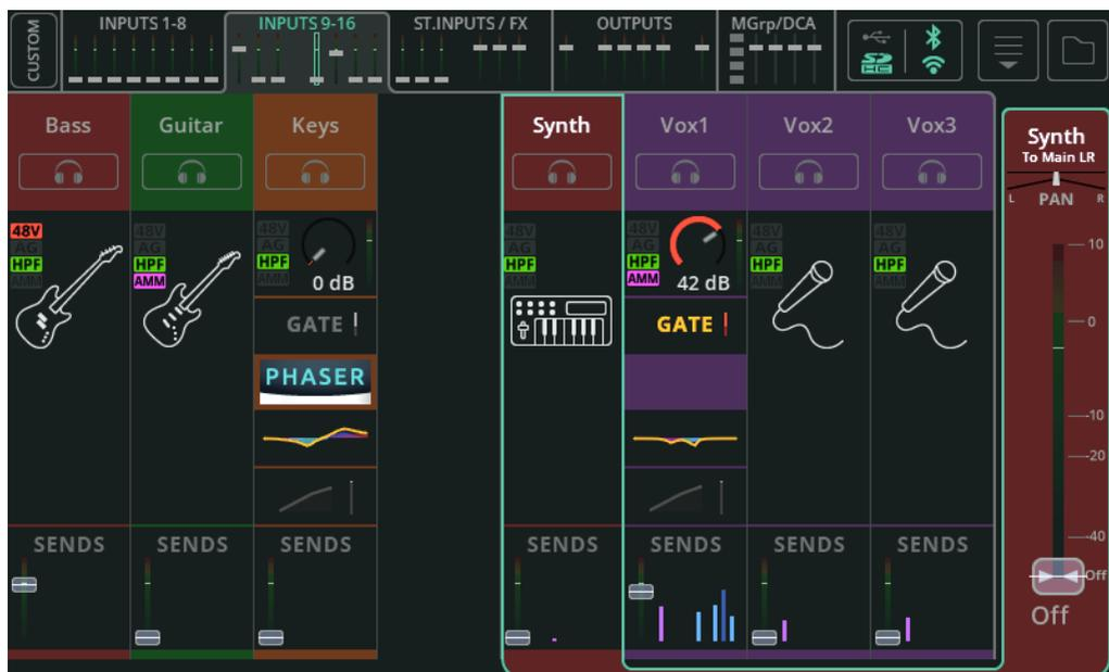
La vue de banque affiche une des cinq banques à la fois, chacune montrant jusqu'à huit canaux d'entrée, d'effet ou de sortie, ainsi que les groupes de Mutes et les DCA. Changez de banque à l'aide des onglets à mini-faders et indicateurs de niveau en haut (lorsque vous utilisez l'écran tactile d'une CQ-12T ou CQ-18T) ou en bas à gauche (lorsque vous utilisez l'application CQ-MixPad).
