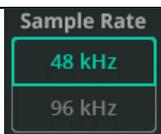
3. Sélectionnez la fréquence d'échantillonnage (**Sample Rate**). 48 kHz permet d'allonger la durée d'enregistrement et d'enregistrer plus de canaux avec une qualité moindre. 96 kHz permet d'enregistrer un maximum de 16 canaux pendant une durée plus courte, mais avec une qualité supérieure.
