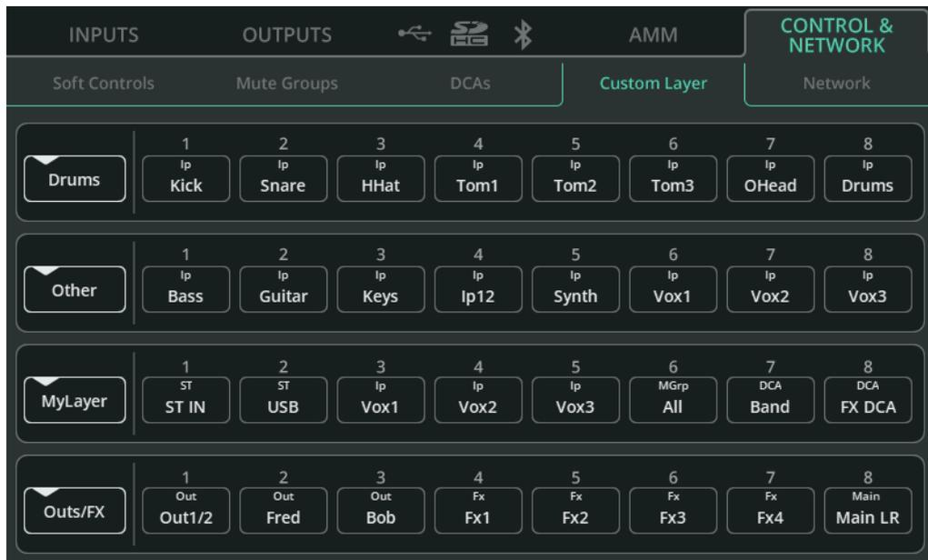
La couche personnalisée (Custom Layer) permet aux quatre premières banques des écrans PROCESSING et FADER de contenir n'importe quelle combinaison de 8 canaux ou tranches de contrôle. Activez ou désactivez la couche personnalisée à l'aide du bouton **CUSTOM** situé dans le coin supérieur gauche des écrans PROCESSING ou FADER.
