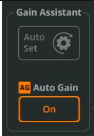
8. Une fois la fonction de réglage automatique **Auto Set** terminée, la fonction de gain automatique **Auto Gain** est activée. L'entrée est maintenant prête pour le traitement et l'enregistrement ou l'ajout à un mixage.
