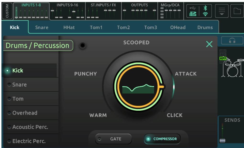
Canal simplifié « à un bouton » qui comporte des types d'instruments ou de sources sur le côté gauche.
