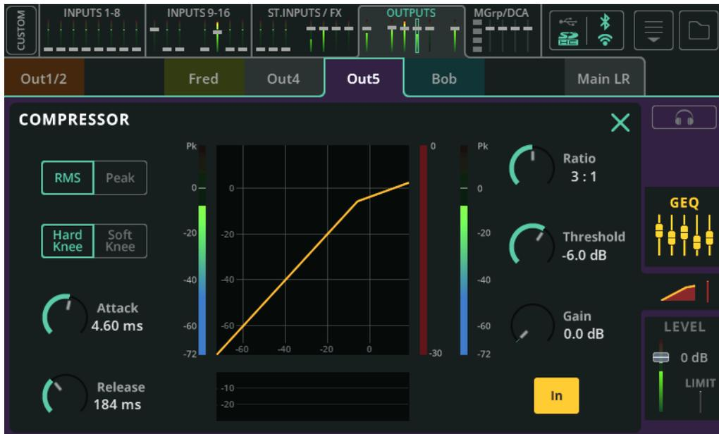
Ce compresseur sert à contrôler et réduire la dynamique du signal.
