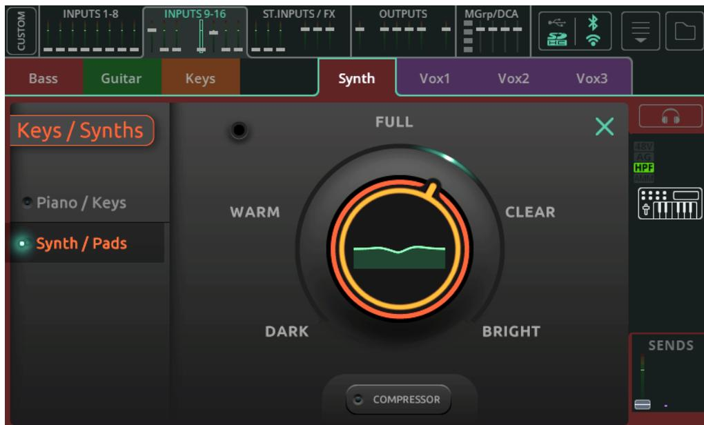
La CQ propose des canaux simplifiés pour une variété de sources audio courantes, qui sont des moyens de régler rapidement et facilement de nombreux paramètres de traitement de canal avec seulement quelques commandes. Cela permet de mettre le mixage en place beaucoup plus rapidement qu'avec des commandes conventionnelles et, si un contrôle plus poussé est nécessaire, les canaux simplifiés peuvent à tout moment être convertis en canaux complets.
