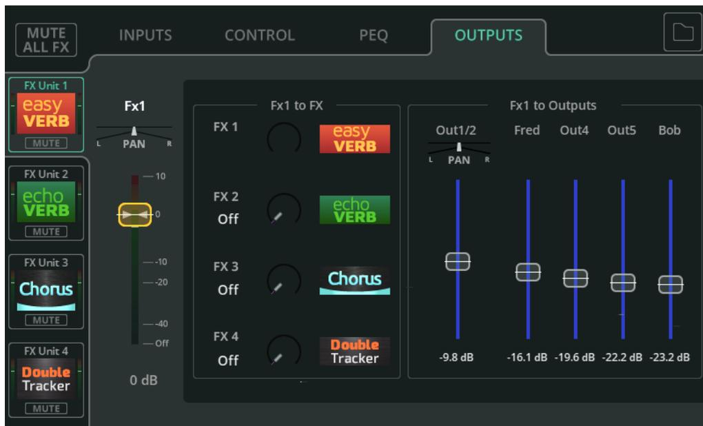
L'onglet OUTPUTS affiche les mêmes informations que l'onglet SENDS d'un canal d'effet dans l'écran PROCESSING et contrôle la destination du signal d'effet.
