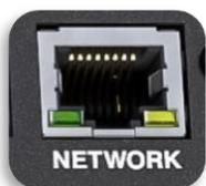
RJ45, Fast Ethernet. Pour les messages de contrôle de réseau uniquement.
