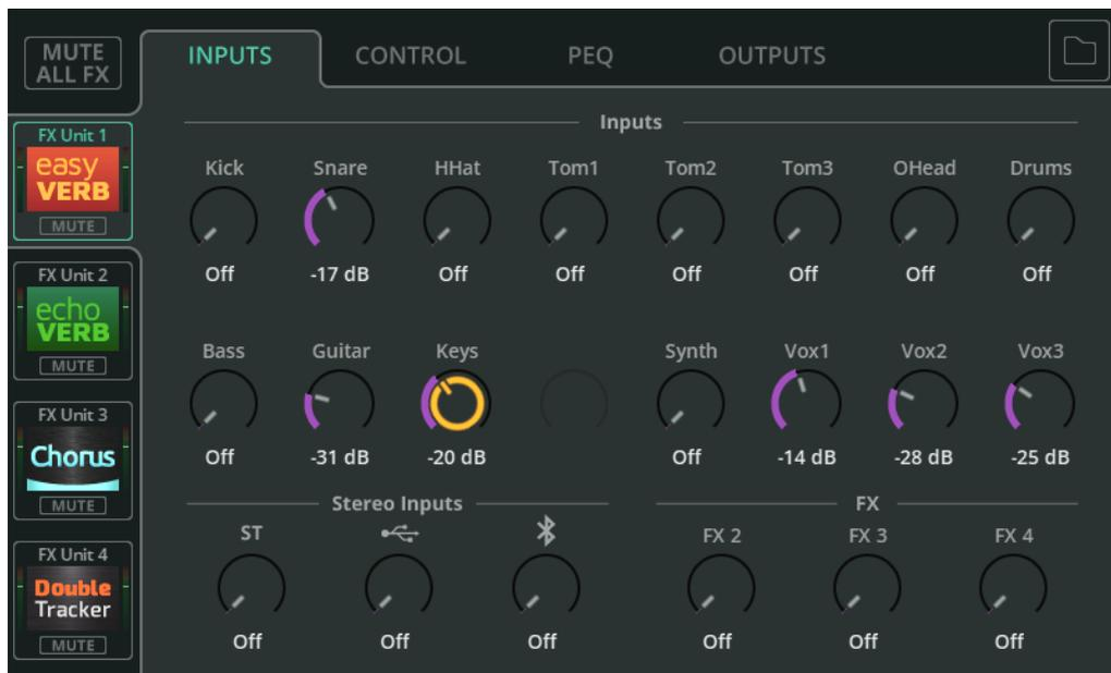
Permet de visualiser et de régler les niveaux de départ des canaux d'entrée et des autres unités d'effets vers l'unité d'effet sélectionnée. Les signaux des différents canaux sont additionnés avant d'être traités par l'unité d'effet.
