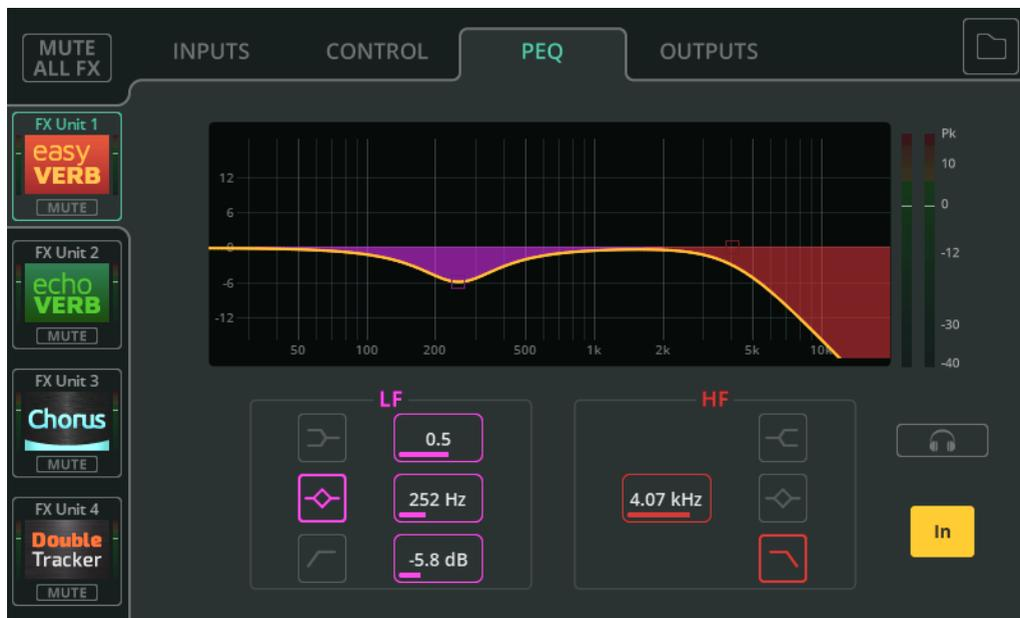
Cet égaliseur paramétrique à 2 bandes permet de corriger la tonalité du signal traité en atténuant ou en renforçant différentes fréquences.
