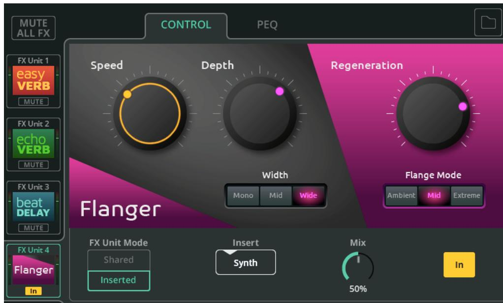
Le Flanger replie le signal sur lui-même et utilise un délai à modulation très rapide pour créer un effet métallique changeant.
