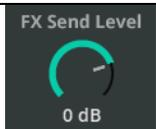
5. Réglez le niveau de départ d'effet (**FX Send Level**) à 0 dB comme point de départ. Il peut être réglé à tout moment pour contrôler le niveau général du signal envoyé à l'unité d'effet.
