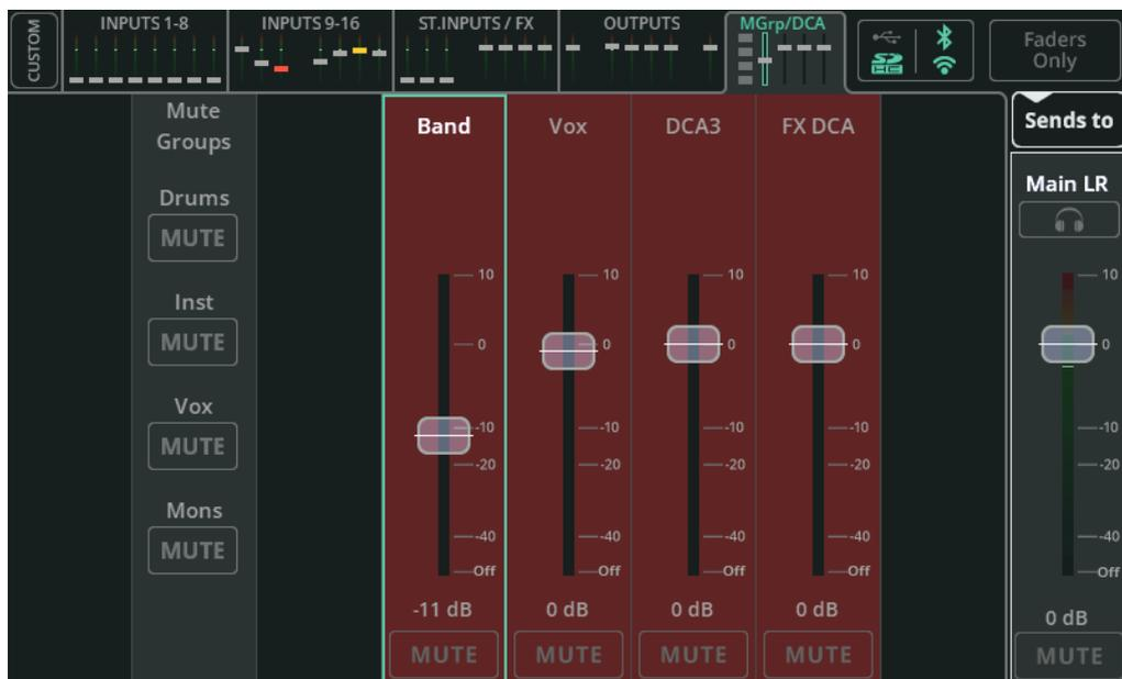
L'onglet de banque **MGrp/DCA** est toujours accessible, même lorsque la couche personnalisée (Custom Layer) est active. Il comprend des commandes pour les quatre groupes de Mutes et les quatre DCA (Digitally Controlled Amplifiers ou amplificateurs à commande numérique).
