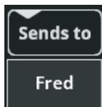
1. Ouvrez l'écran **FADER** et utilisez le bouton **Sends to**, au-dessus du fader du côté droit, pour sélectionner une sortie vers laquelle envoyer le signal.
