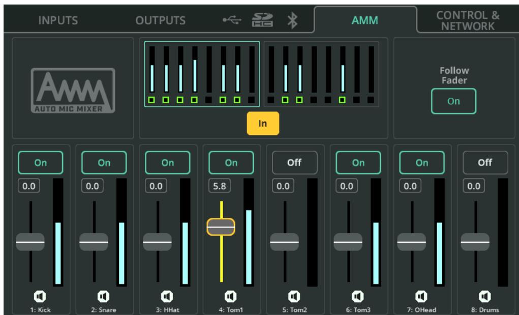
Le mixeur automatique de micros de la CQ utilise un algorithme de partage de gain conçu pour les applications vocales à multiples micros telles que les conférences, les réunions, la radiodiffusion et les podcasts. Il peut être utilisé sur chaque canal d'entrée mono de la CQ avec deux banques affichées en haut de la page.
