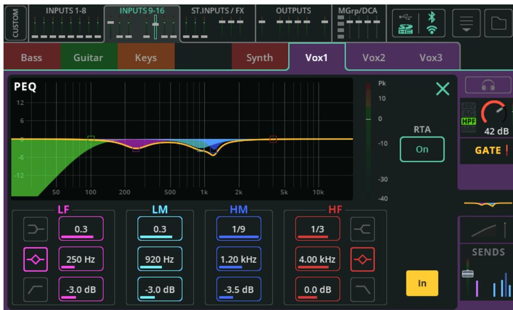
Cet égaliseur paramétrique à 4 bandes permet de corriger la tonalité du signal en atténuant ou en renforçant différentes fréquences.
