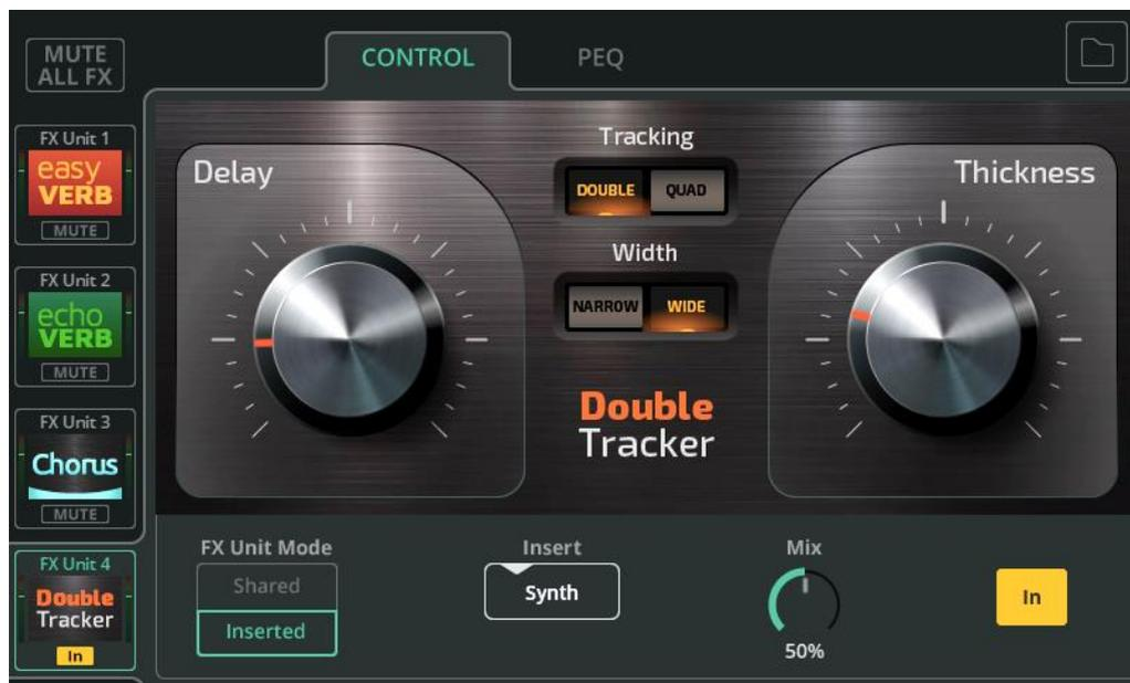
**FX Unit Mode** (mode de l'unité d'effet) – « Shared » (mode partagé) permet à plusieurs canaux d'envoyer simultanément leur signal à l'unité d'effet, et à la sortie de l'unité d'effet d'être envoyée à la sortie principale Main LR, aux sorties individuelles ou à d'autres unités d'effet avec des niveaux différents en utilisant soit l'écran PROCESSING / SENDS, soit l'écran FADER. Le mode Shared est généralement utilisé pour les réverbérations et les délais.
