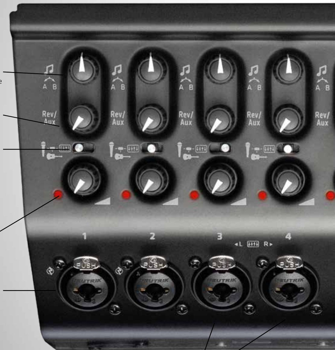
Les canaux 3 et 4 peuvent être couplés en stéréo pour les sources stéréo de niveau ligne (par exemple un clavier ou un contrôleur de DJ)
