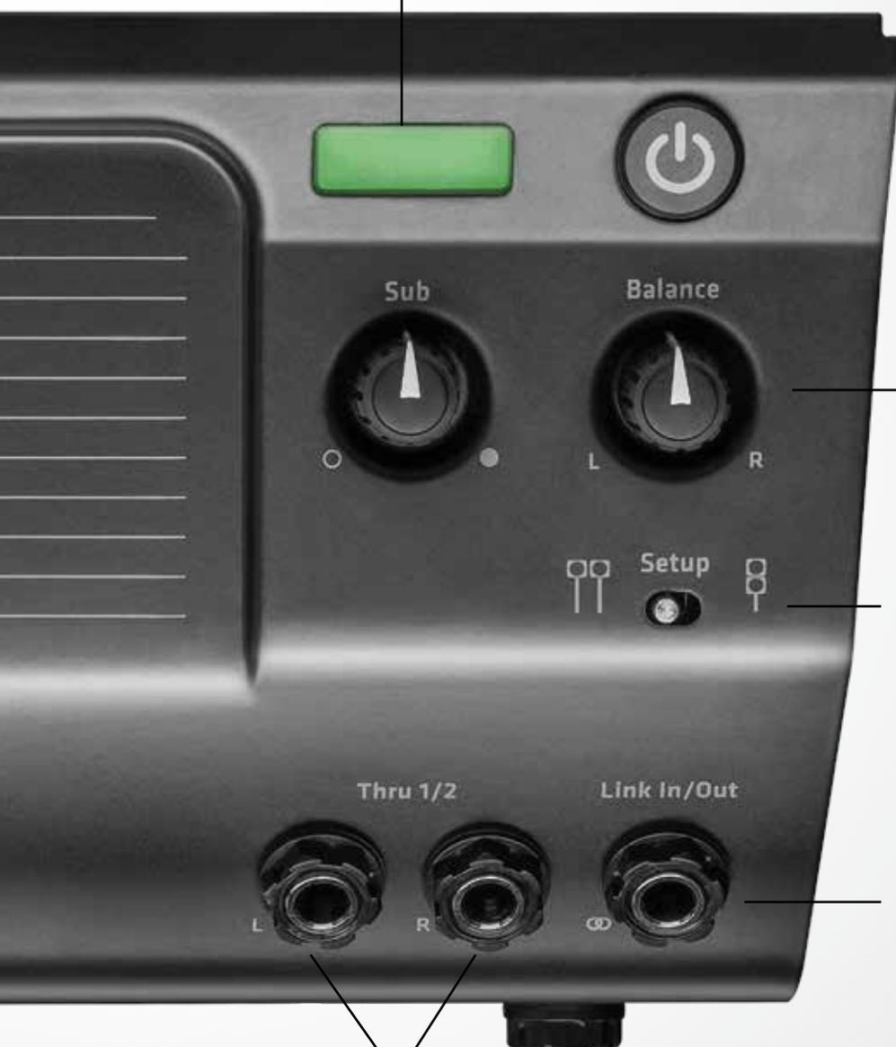
Sub contrôle le niveau du caisson de graves.
