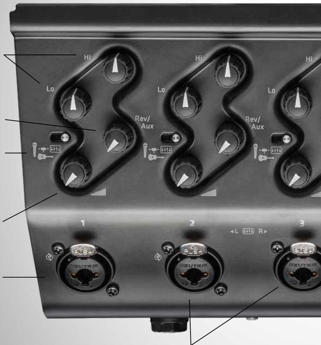
Les canaux 2 et 3 peuvent être couplés en stéréo pour les sources stéréo de niveau ligne (par exemple un clavier ou un contrôleur de DJ)
