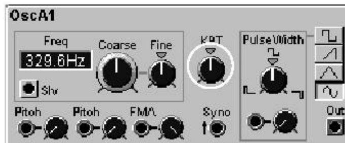
Tout pitch bend apparaissant à l'entrée MIDI IN sera ajouté au KBT. Plus d'information sur l'échelle du pitch bend à la section "Pitch bend" page 52. Si vous faites un patch avec séquenceur, avec le KBT actif sur les oscillateurs, vous pouvez transposer la séquence en temps réel en appuyant sur les touches du clavier du Nord Modular (ou de votre clavier maître). Si des filtres dans un patch ont le KBT actif, la fréquence de coupure suivra aussi le clavier.
