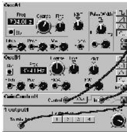
Dans cet exemple l'OscA est le moduleur et l'OscB le modulé. Avec le bouton "unipolaire" enfoncé, le système fonctionne comme une modulation d'amplitude.
