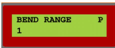
Le pitch bend est ajouté au signal de contrôle de la sortie Note des modules "Keyboard" et de la fonction KBT. Cet écart est de 0 à 24 demi-tons si le KBT est réglé à 1. Les LFOs et les filtres qui utilisent le paramètre KBT seront eux aussi affectés par les données de pitch bend entrantes.
