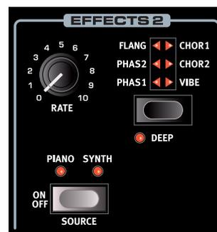
**EFFECTS 2** offre une sélection d'effets de modulation incluant deux types de phaser, un flanger, deux types de chorus et un effet vibe. Chaque effet a sa propre vitesse contrôlée par le bouton **RATE** d'Effects 2.
