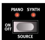
Les touches **ON/OFF** servent à activer une fonction ou un groupe de fonctions comme les effets et ont une LED adjacente pour indiquer le statut On/Off et quelquefois aussi la source ou la section.
