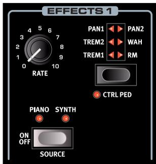
La section **EFFECTS 1** offre six types d'effets de modulation. Utilisez sa touche de sélecteur pour choisir parmi les réglages disponibles et le bouton **RATE** pour régler la vitesse de l'effet sélectionné.
