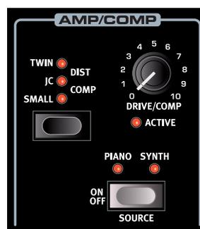
L'unité **AMP/COMP** comprend des simulations sophistiquées d'amplificateurs et de baffles, un réglage pour une distorsion à lampe polyvalente et un pratique effet compresseur. L'ampleur de la saturation ou de la compression se contrôle à l'aide de la commande **DRIVE/COMP**. La LED indique si une saturation est activée et s'allume chaque fois que le compresseur agit.
