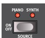
Les touches **ON/OFF** servent à activer une fonction ou un groupe de fonctions comme les effets et ont une LED adjacente pour indiquer le statut On/Off et quelquefois aussi la source ou la section.
