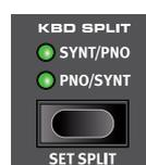
Le clavier du Nord Piano 4 peut être divisé en deux zones, avec le son de la section Sample Synth à gauche et le son de la section Piano à droite – en cas de réglage sur **SYNT/PIANO** – ou en configuration inverse avec le réglage **PIANO/SYNT**.
