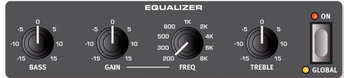
La fréquence de correction des graves (**BASS**) est de 100 Hz, celle des aigus (**TREBLE**) de 4 kHz et la bande de correction des médiums peut être réglée entre 200 Hz et 8 kHz au moyen du bouton **FREQ**.
