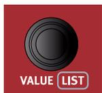
Les *molettes* du Nord Wave 2 sont des boutons sans positions fixes de début et de fin de course, servant à naviguer dans les paramètres et les réglages de façon progressive. La molette **VALUE** en est un exemple. Dans ce manuel, les molettes sont parfois appelées *encodeurs*.
