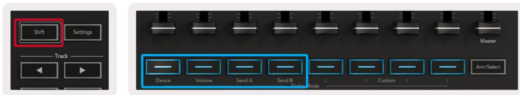
Remarque : un mode ne peut pas être attribué simultanément aux potentiomètres et aux faders. Si un mode est déjà assigné aux potentiomètres, les boutons de Fader correspondants apparaîtront en rouge lorsque vous maintiendrez la touche Shift enfoncée, et le fait d'appuyer sur un bouton de Fader dans cet état n'affectera pas ce mode aux faders.
