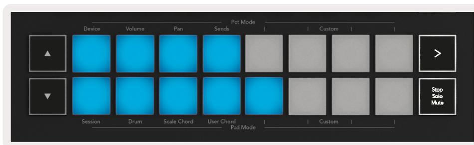
Pour supprimer un accord affecté à un pad, il suffit de maintenir enfoncé le bouton Stop/Solo/Mute ; les pads auxquels des accords ont été assignés deviendront rouges, et en appuyant sur un pad rouge, l'accord correspondant sera effacé. Une fois supprimé, le pad ne s'allumera plus.
