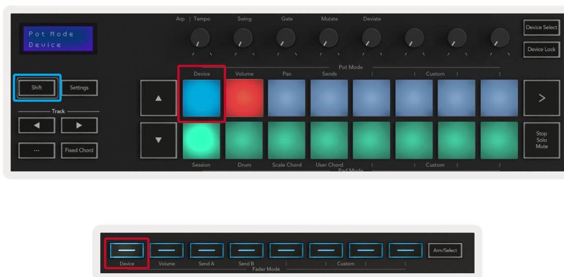
Si la piste contient un Rack d'Effets ou d'Instruments, les faders ou potentiomètres assignés se synchronisent aux 8 commandes macros du premier Rack. L'image ci-dessous représente un preset du Rack d'Instruments appelé "Percussion 1". Dans cet exemple, les 8 potentiomètres du Launchkey contrôlent une multitude de paramètres importants, notamment les volumes de l'échantillon sonore, les points de départ et d'étirement, ainsi que les valeurs Dry/Wet des effets de délai et de réverb.
