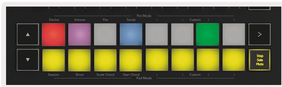
**Clips (multicolore)** - la quatrième pression (après avoir basculé entre Stop, Solo et Mute) rétablit la fonction des pads inférieurs en mode Session par défaut, dans lequel la rangée inférieure de pads représente à nouveau les clips.
