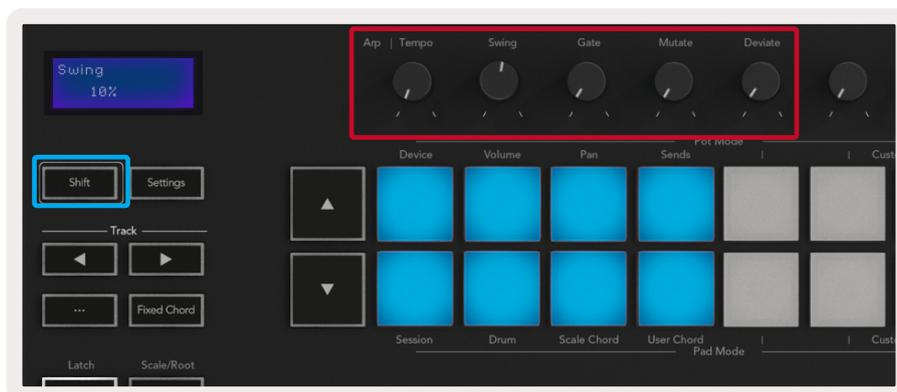
**Tempo** – Ce potentiomètre accélère ou ralentit votre arpège selon la vitesse définie par la fonction **Arp Rate**. Lorsque le Launchkey est utilisé en tant que contrôleur autonome, la valeur de ce contrôle va de 60 BPM à 187 BPM. Cependant, lorsqu'il est synchronisé à Ableton Live, ce potentiomètre n'a aucun effet.
