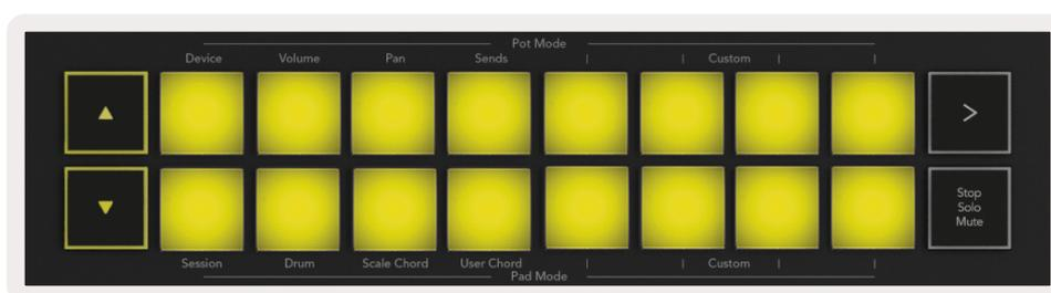
Lorsque vous utilisez les Drum Racks d'Ableton, le mode Drum sélectionne – en plus de déclencher des sons – le pad du Drum Rack qui lui est associé. Cela signifie qu'en le relâchant, le dernier pad du Drum Rack joué s'illumine en blanc ; Ableton Live affiche alors le pad du Drum Rack sélectionné à l'écran.
