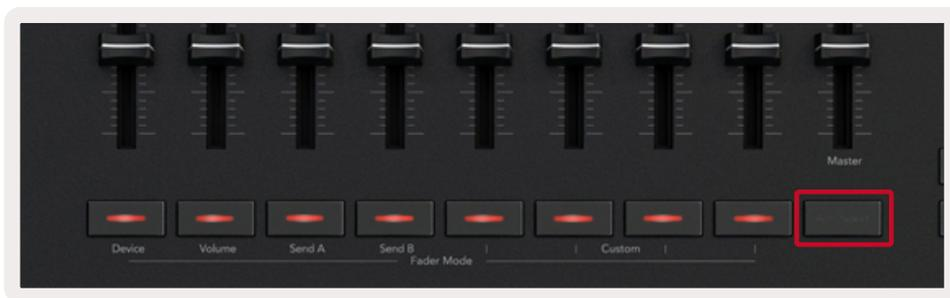
En position "Select" ("Sélectionner"), la couleur des boutons correspondra à celle des pistes de Live. Une pression sur un Bouton de Fader (encadré en bleu) sélectionne la piste associée.
