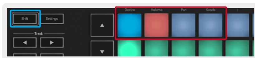
**Le Mode Device** - Associe les potentiomètres aux paramètres, ou "smart controls" (commandes intelligentes) du plug-in sur la piste sélectionnée. Pour les pistes d'instruments, il s'agit d'un éventail de paramètres dédiés à l'instrument. Pour assigner les potentiomètres au mode Device, appuyez sur le pad Device (en haut à gauche) tout en maintenant la touche Shift enfoncée. Dorénavant, lorsque vous tournerez un encodeur, le paramètre du plug-in qui a été modifié et sa valeur actuelle
