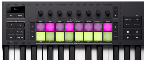
Les pads Launchkey 49 reflétant les états Mute et Solo du mélangeur sur les pads.
