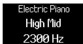
Contrôle de la fréquence de la bande High Mid-EQ avec l'encodeur 5.
