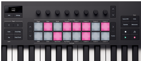
Les pads de Launchkey représentant les notes dans le séquenceur.
