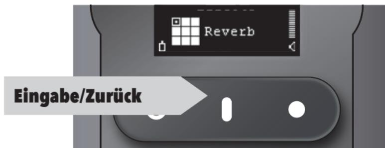
Sie können durch die **verschiedenen Effekte** scrollen, indem Sie die ‚Auf‘- oder ‚Ab‘-Tasten drücken oder den Effekt in der HyVibe Mobile App antippen.
