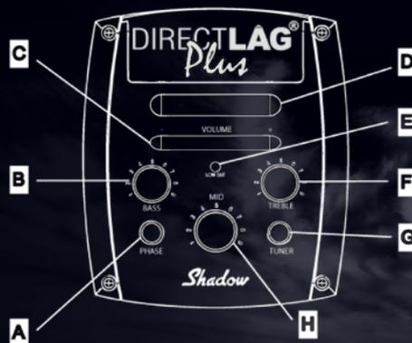
**A PHASE** : le signal est dérivé à travers l'appareil avec mise en mémoire tampon, mais sans optimisation de l'égaliseur de préamplificateur.
